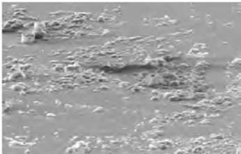
*x 1000 vergrössertes Bild eines normalen Duschglases (ohne Beschichtung) von einer Dusche, die täglich genutzt wurde: viele sichtbaren Stellen.*
