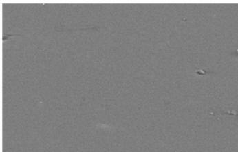
*x 1000 vergrössertes Bild von SGG Timeless Duschglas von einer Dusche, die täglich genutzt wurde: keine sichtbaren Stellen.*
