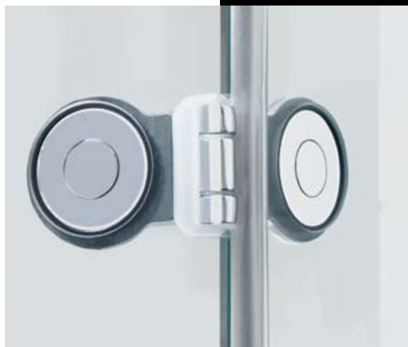
Messingbeschläge mit versenkter Punktbefestigung. Durchgehende Dichtung am Fixteil. Einsatz im Glasausschnitt dient als Anschlagsschutz bei Türöffnung nach außen.
