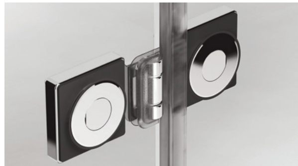
Messingbeschläge mit versenkter Punktbefestigung. Durchgehende Dichtung am Fixteil. Einsatz im Glasausschnitt dient als Anschlagsschutz bei Türöffnung nach außen.
