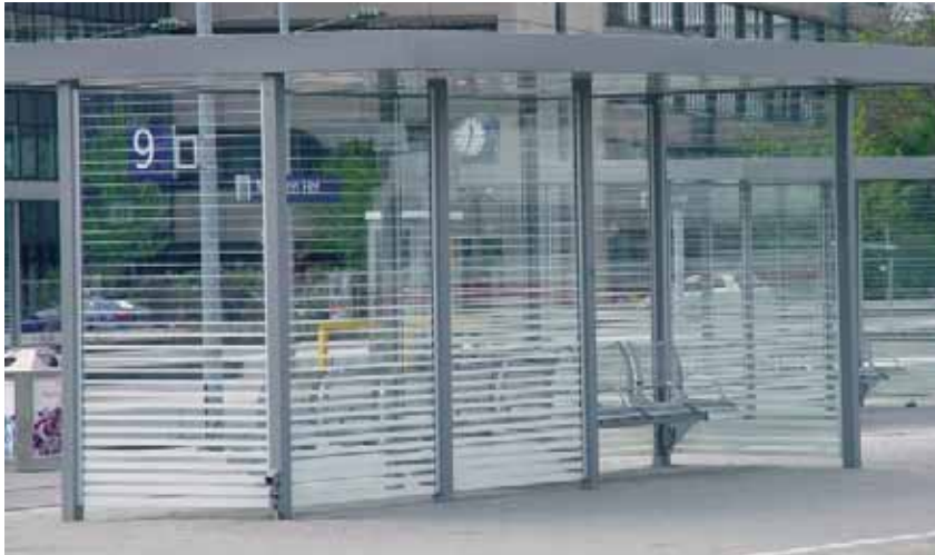
Wartehäuschen, kleine Lärmschutzwände, Windschutz-Verglasungen, Balkon-Brüstungen etc. lassen sich auch nachträglich gut mit horizontalen oder vertikalen Streifen ausrüsten. Dieses Objekt in München wurde von Beginn an mit einem Siebdruck versehen.
